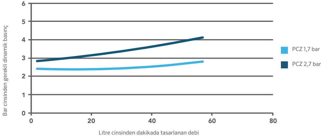
PCZ101: Tasarlanan çıkış basıncı için gerekli giriş basıncı
